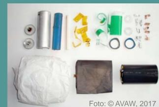
**DEMONTAGE** Nach der Sammlung werden große Lithium-Ionen Batterien aus Elektroautos zerlegt und die einzelnen Bauteile demontiert. Dies ist wichtig um Wert- und Schadstoffe voneinander zu trennen und die große Vielfalt an Materialien in verschiedene Recyclingwege zu führen. Der größte Anteil an der Batterie – die Zellen (von 10 bis 8.000 Stück pro Batterie) – gehen dann in eine eigene Aufbereitung. Schematischer Ablauf im End-of-Life einer Batterie:
