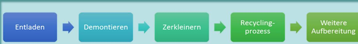
**RECYCLING** Im Recyclingprozess werden die Batterien zerkleinert, sortiert und mit Hilfsstoffen wie Wärme und Chemikalien verwandelt. Ziel ist es u.a. Wertstoffe wiederzugewinnen. Verfahren dazu sind:
