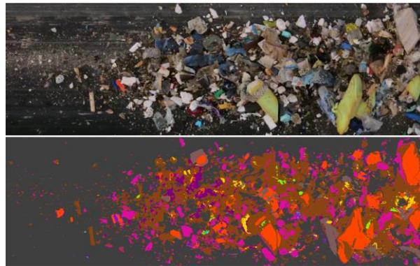
Copyright ReWaste F. Links: installierte Multisensorenbrücke zur Aufnahme von Spektral-, Video-, und Volumenstromdaten in einer Aufbereitungsanlage. Rechts: Videobild (oben) und Materialanalyse (unten) gemischten Gewerbeabfalls.
